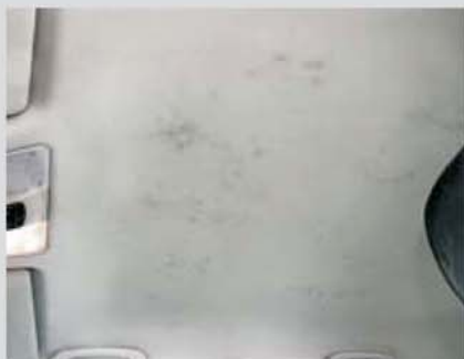
Tapiterie extrem de murdara care nu poate fi îndepartata prin curatarea normala. De asemenea, nu sunt acceptate rupturi ale materialelor.
